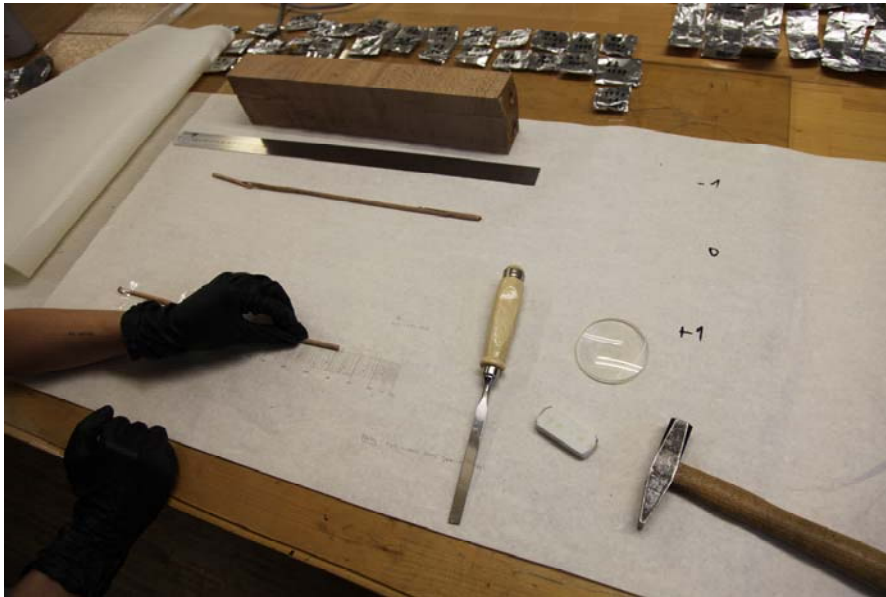
Abbildung 4: Dendrochronologische Zuordnung und Entnahme der Baumringe aus Bohrkerne der Rotbuche.
